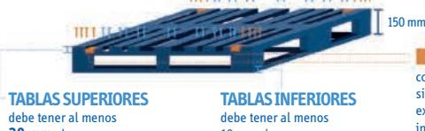
TABLAS SUPERIORES E INFERIORES debe tener al menos 18 mm. de espesor
